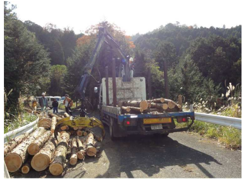
グラップル付トラックによる木材の積み込み
