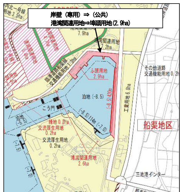
図2-1-2 船渠地区 埠頭計画図 (変更後)
